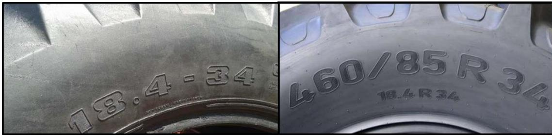
Figura 1. Nomenclatura de un neumático diagonal (izquierda) y un radial (derecha).
