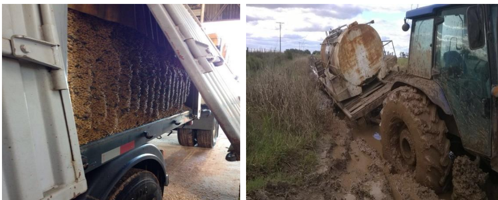
La foto 1, (Montes de Oca, Sta Fe) muestra que el grano húmedo no cae al abrir las compuertas del camión. Gentileza de Alejandro Ramello. La foto 2 (Las Parejas, Sta Fe) muestra el estado de los caminos. Gentileza de Néstor Bessone.
